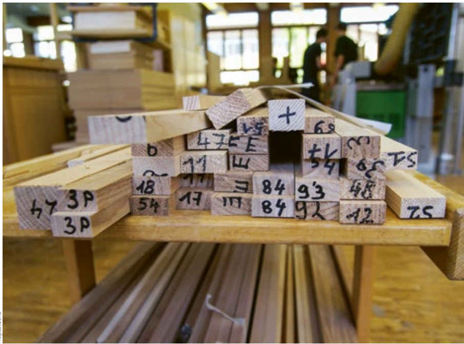
Comme les tiges du fuselage en frêne prêtes pour l'assemblage du fuselage, tout le bois de construction du «fauxdufaux» a été fourni pas Deligno SA à Sugiez.
